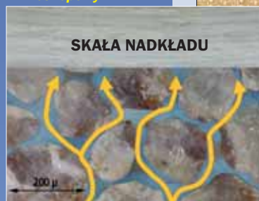
Rycina 1 Zatłoczony CO 2 , lżejszy od wody, ma skłonność do wznoszenia się, jednak taki ruch jest zatrzymywany przez leżące wyżej nieprzepuszczalne warstwy skalne
