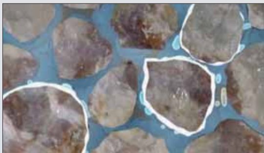
Rycina 2 Migrujący gęsty CO 2 (jasne, niebieskie bąbelki), rozpuszcza się i reaguje z ziarnami skał, prowadząc do wytrącania się minerałów węglanowych na obrzeżach ziarn (białe)
