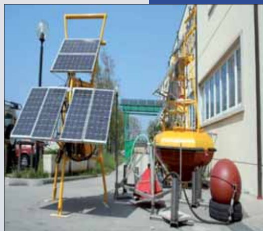
Rycina 2 Boja monitorująca z panelami słonecznymi jako źródło energii, pływaki i aparaty służące do pobierania próbek gazu z dna oceanu
